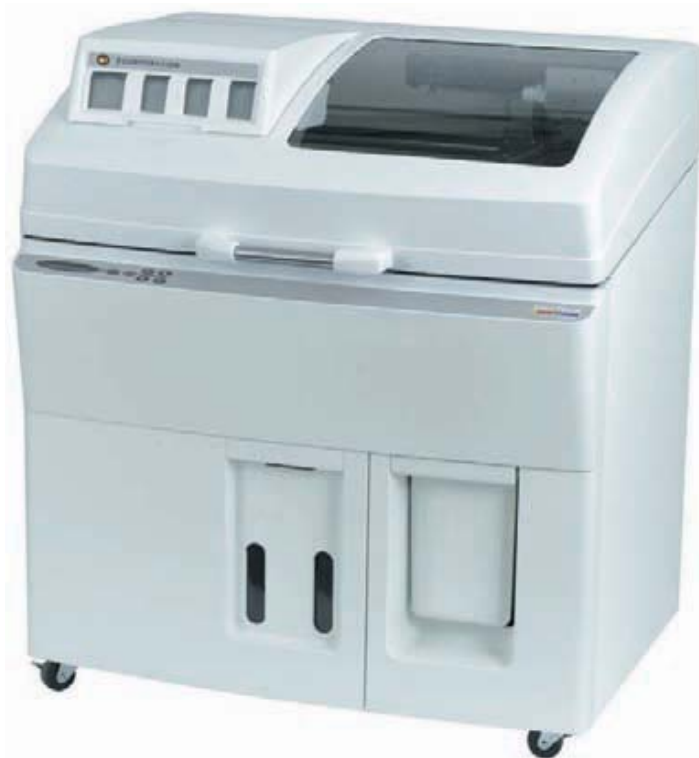
Molti dei modelli sono stati stampati con il sistema Z510 Spectrum: velocità di stampa 2 layers per minuto; spessore dei layers da 0,059 mm a 0,203 mm; dimensioni 254x356x203 mm; risoluzione 600x540 dpi
